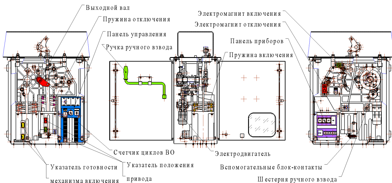
Рисунок 38. Общий вид привода
