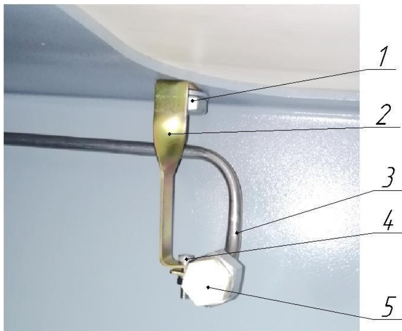
Рисунок 16. Демонтаж транспортировочных деталей
