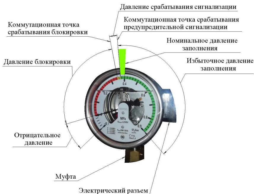
Рисунок 35. Устройство сигнализатора давления элегаза
