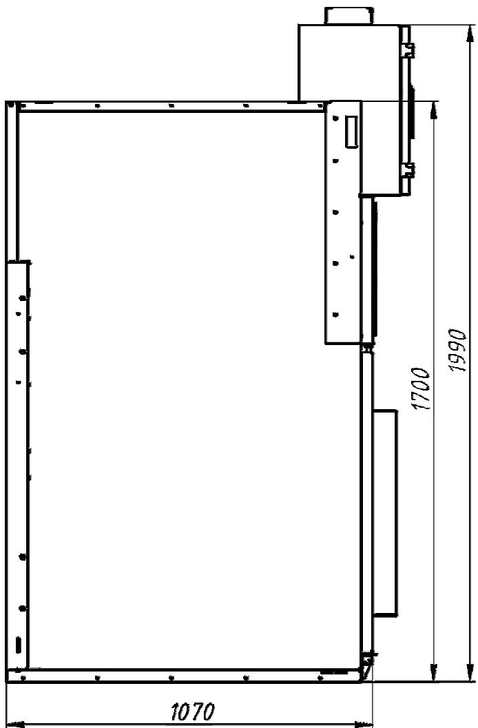
По согласованию с заводом-изготовителем шкафы КРУ серии КСО2-20 могут быть изготовлены с отклонениями от типовых размеров приведённых выше.
