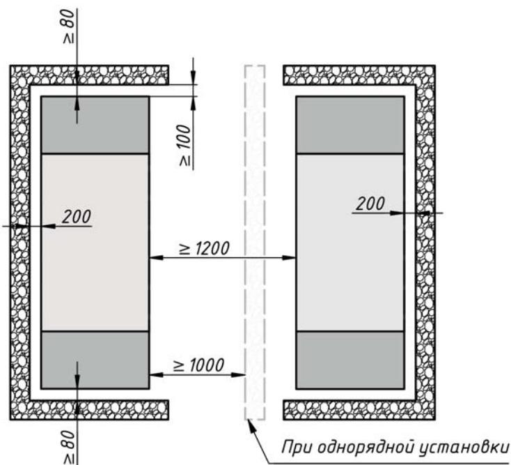
На рисунках указаны расположение и размеры проходных отверстий кабелей под разные ячейки.
